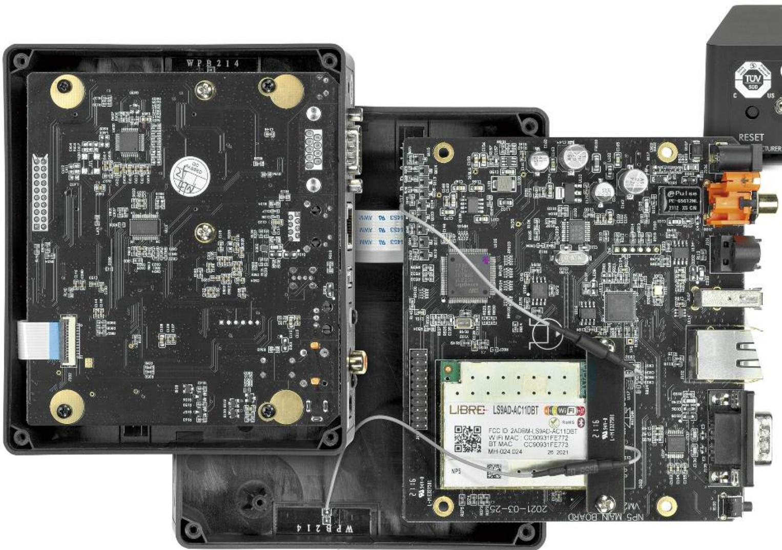
Der NP 5 entspricht dem Streamingmodul SM 35, das Primare optional für CD-Player und Vorstufen anbietet. Für den separaten Betrieb musste ein Anschluss für ein externes Netzteil geschaffen werden. Das Kunststoffgehäuse macht das Anschrauben einer WLAN-Antenne überflüssig
