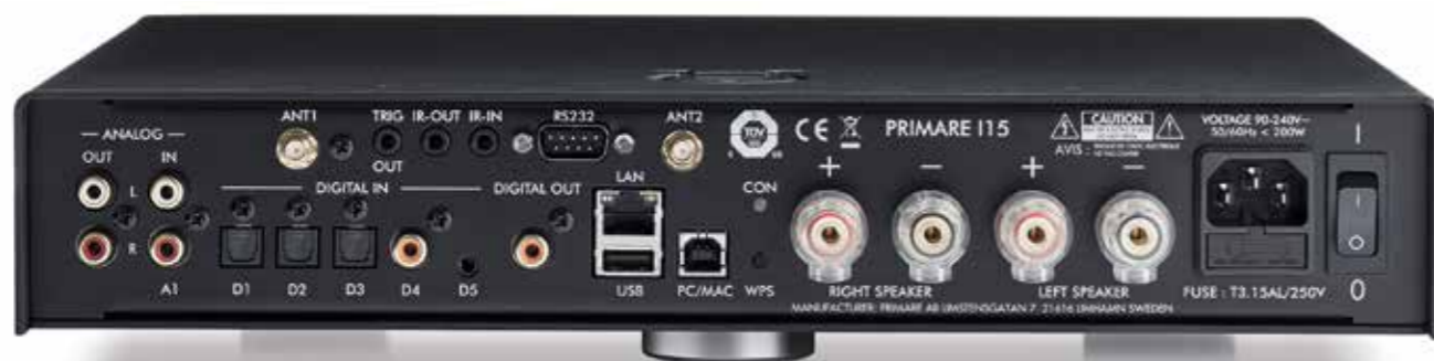
Digitale Konnektivität steht beim I 15 im Vordergrund: Den sechs S/PDIF-Zugängen steht gerade mal ein analoger Anschluss gegenüber. Immerhin gibt's einen Recorder-Abgriff.
