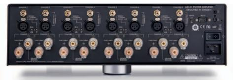
Für den Mehrkanaltest wählten wir eine 5.1-Installation. Als Vorverstärker nahmen wir einen Denon AVR-X3600H. Dieser AV-Receiver der oberen Mittelklasse verfügt über Pre-Outs als Cinch. Die ersten drei Endstufenpaare wurden für drei Frontlautsprecher gebrückt. Die verbleibenden zwei einzelnen Endstufen befeuerten die Rear Speaker und Sub wie gewohnt per LFE.
