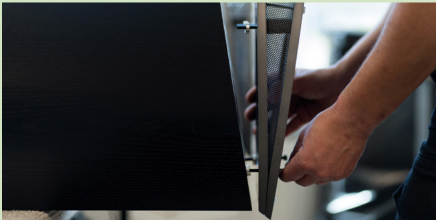
Der Gehäuseboden der R3-Standboxen ist nach hinten abgeschrägt, um stehende Wellen und damit Resonanzen zu verhindern. Für einen geraden Stand der Lautsprecher sorgt ein aufgeschraubter Sockel aus Metall.
