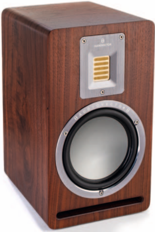
SOLIDE ARBEIT: Das Bassreflex-Gehäuse kommt ohne sichtbare Spaltmaße aus. Die frontseitige, schlitzförmige Bassreflex-Öffnung bewährt sich bei wandnaher Aufstellung.
